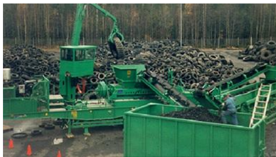
شکل (1-3) نمونه‌ای از دستگاه‌های تولید پودر لاستیک [7]
