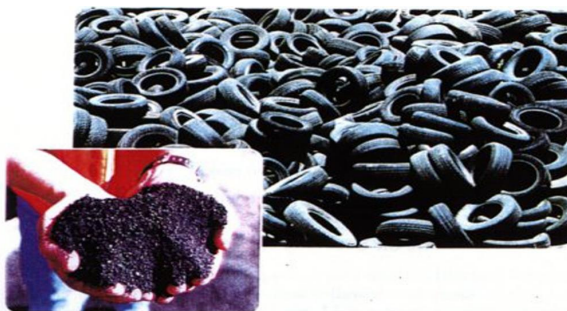
شکل (1-4) تولید پودر لاستیک از تایرهای پسماند [7]
